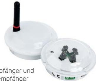
Funkempfänger und Infrarotempfänger
