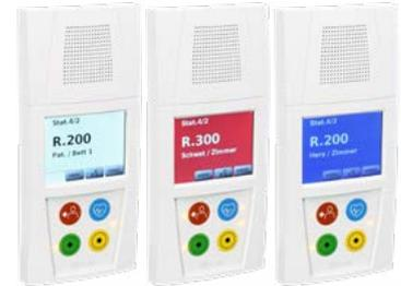
Bis zu 6 verschiedene, frei programmierbare Tasten können im Touch-Display angezeigt werden. So ist es möglich, mit nur einem Tastendruck die gewünschte Funktion zu wählen.
